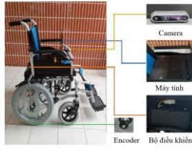
Hình 4.4. Xe lăn với camera RGB-D, Encoder và máy tính.
